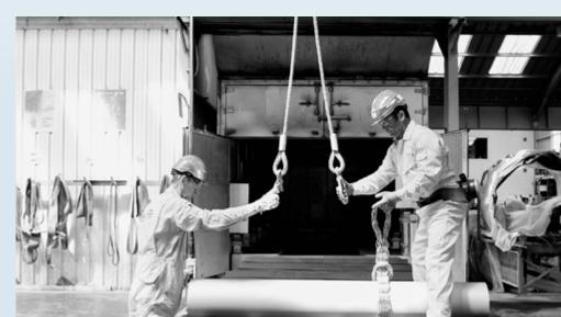
Erhitztes Rohr vor dem Auftragen der Epoxidpulverbeschichtung
