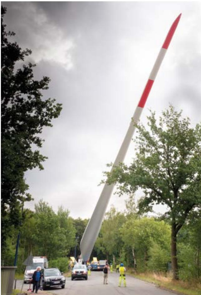
Logistische Herausforderung bei dem Transport eines 73 m langen Rotorblatts einer Delta4000-Anlage
