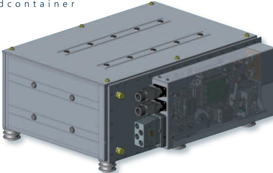
*Der Energieinhalt des gewichtsoptimierten Standardcontainers beläuft sich auf 15,2 kWh. Die dauerhafte Lade- und Entladeleistung beträgt 50 kW, in der Spitze sind bis zu 80 kW möglich. Dabei verfügt der Standardcontainer über ein ISO 26262 komplementäres Design sowie ein ECE R 100 Zertifikat, dessen Erreichung im abgelaufenen Geschäftsjahr im Zuge der Validierung im Fokus stand.*
