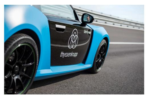
Steer-by-Wire Testfahrzeug im Einsatz
