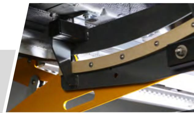
Bei dem Produkt handelt es sich um eine robuste und wartungsarme Nachrüstlösung, die nicht in die Fahrzeugstruktur eingreift und zudem die Bodenfreiheit des Fahrzeugs kaum einschränkt. Bei der Anbindung des Modulsystems haben die EDAG Entwickler die am Fahrzeug vorhandenen Anschraubpunkte genutzt. Somit sind keine Änderungen an der Karosserie notwendig. Zudem wird durch diese Lösung eine einfache und schnelle Montage und Demontage sichergestellt.
