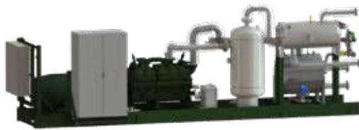
2G-eigene Entwicklung: Die Großwärmepumpe afilia C90 wird mit dem natürlichen Kältemittel Ammoniak ( $\text{NH}_3$ ) betrieben, hat eine Vorlauftemperatur von  $90\text{ }^\circ\text{C}$  und erbringt eine thermische Leistung von rund  $1.200\text{ kW}$ .
