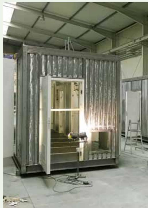
Bereits im zweiten Schritt geht es an die Sonderanfertigungen. Ein Zulieferer fertigt die Container inklusive Türen und vormontierter Rohrdurchführungen sowie einem gasdicht abgetrennten Schaltraum.
