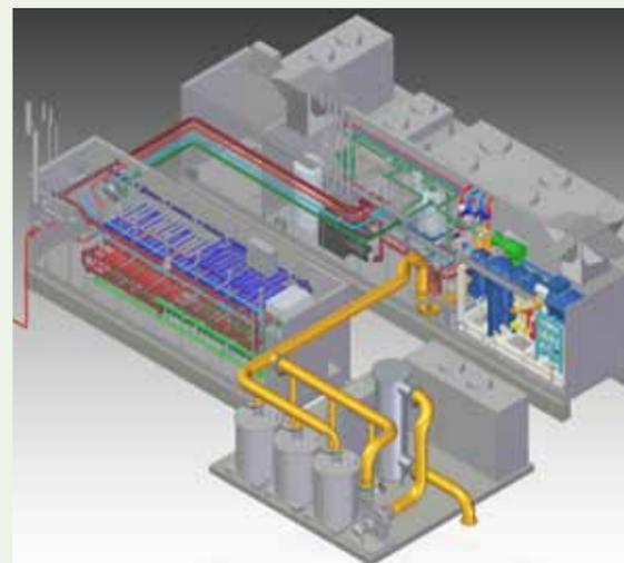
Am Anfang steht ein Plan: Per 3D-Zeichnung wird detailgenau geplant. Neben dem vorderen Maschinencontainer sind 90 Steckplätze für liegende Membranmodule im hinteren Membrancontainer vorgesehen.
