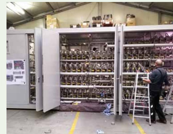
Parallel zur Fertigstellung des Maschinencontainers wird am Membrancontainer getüftelt. Mit der liegenden Anordnung der Membranmodule ist EnviTec in der Lage, mehr als die doppelte Anzahl von Modulen in nur einem Container zu verbauen.
