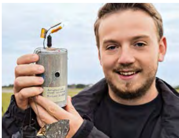
Ein CanSat ist ein „Satellit“ in der Größe einer Getränkedose, der von Schülerteams entwickelt, gebaut und programmiert wird.
