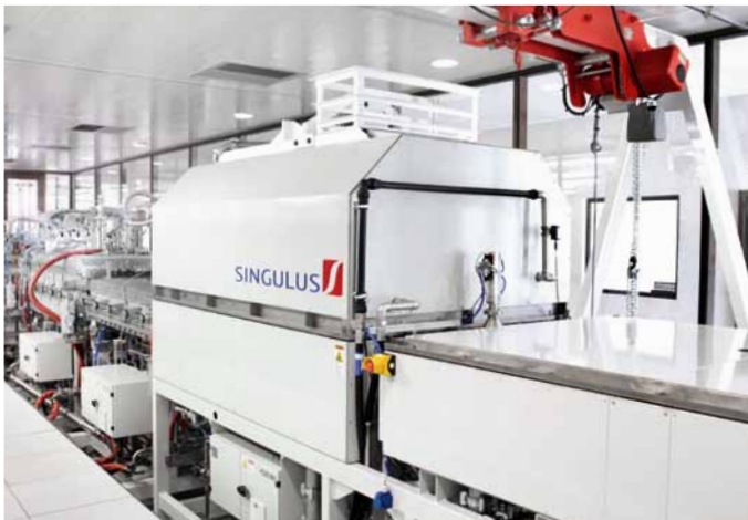
CISARIS Labor- Selenisierungsanlage (geliefert an PTiP Südafrika)
