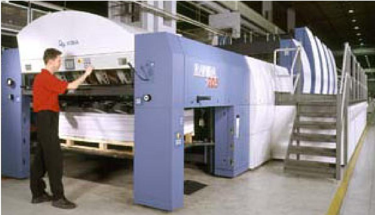
*Die Ende des Berichtsjahres fertig gestellte KBA Rapida 205 ist die größte Bogenoffsetmaschine der Welt und eröffnet den Plakat-, Display-, Bücher- und Verpackungsdruckern neue Perspektiven*
