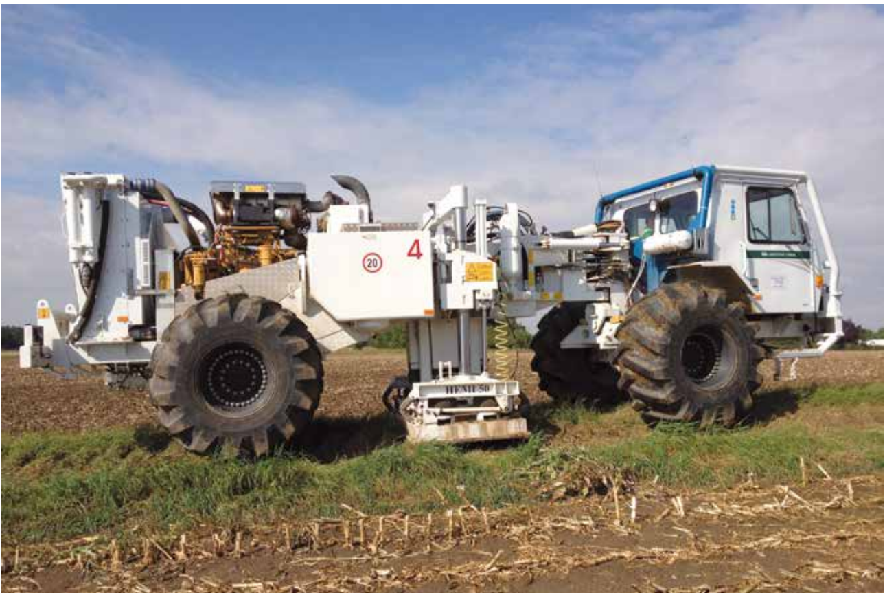
Vibro-Truck bei der 3D-Seismik der Rhein Petroleum
