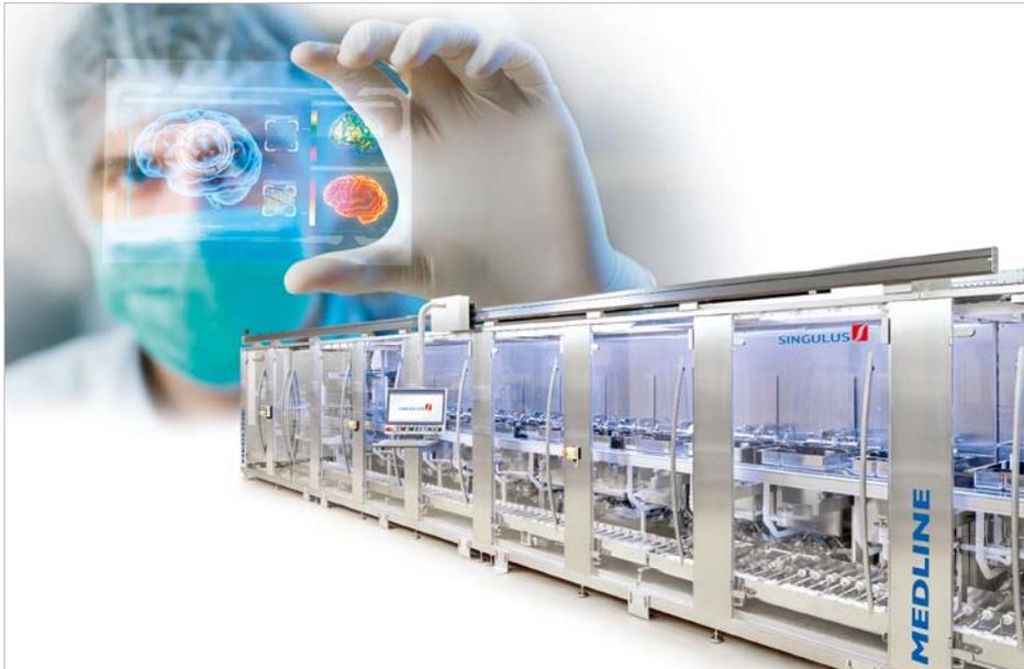
*MEDLINE – Anlage für das Reinigen und Beschichten von Kontaktlinsen. Die MEDLINE Clean reinigt die Kontaktlinsen von Materialresten und beschichtet die Linsen anschließend in einem weiteren Prozessschritt.*
