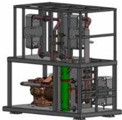
Innerhalb kürzester Zeit entwickelt: Neue Großwärmepumpe mit 200 kW thermischer Leistung und bis zu 90 °C Vorlauf-temperatur
