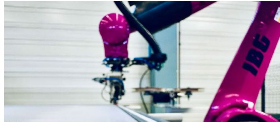
Ein Roboter im Labor und Testcenter „NCAlab“ bei der Abdichtung einer Halbschale
