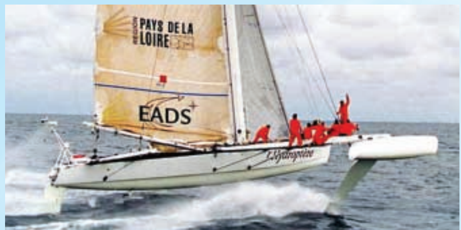
Der Hydroptère gleitet auf Wassertragflügeln – eine revolutionäre Bootskonstruktion, gesponsert von der EADS
