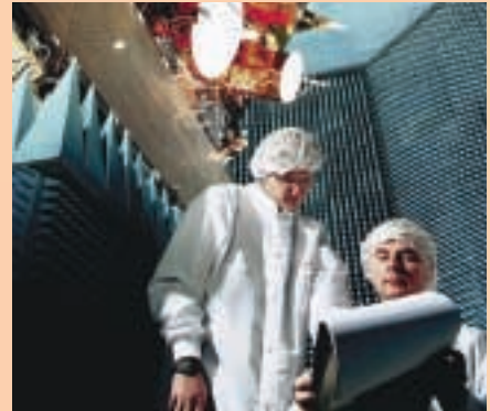
Der Umweltsatellit Envisat wird bei Astrium in einem schalltoten Raum auf die Kompatibilität der verschiedenen Funkfrequenzen getestet
