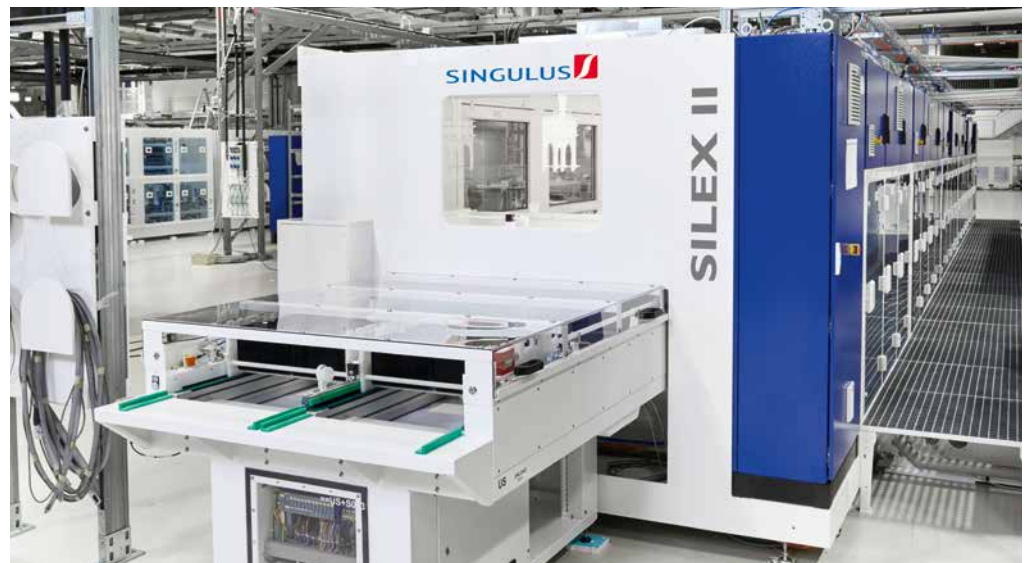
SILEX II – nasschemische Prozessanlage für Hochleistungs-Solarzellen
