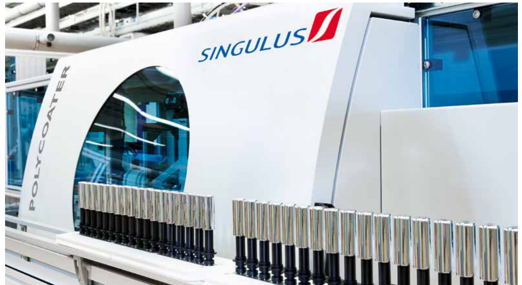
POLYCOATER: Vakuum-Beschichtungsanlage für das Aufbringen von dekorativen und funktionellen Schichten
