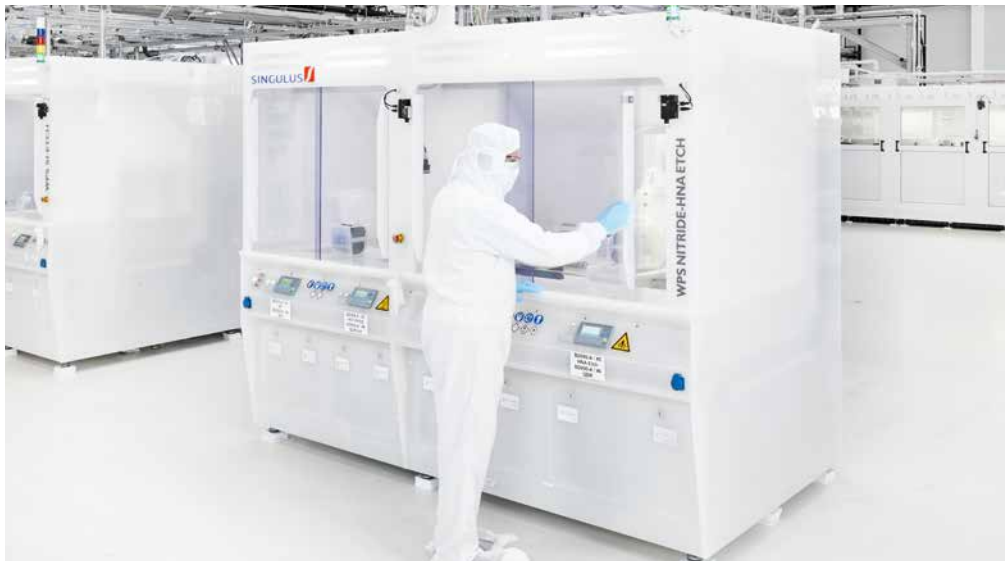
Nasschemische Prozessanlage für Halbleiter-Anwendung
