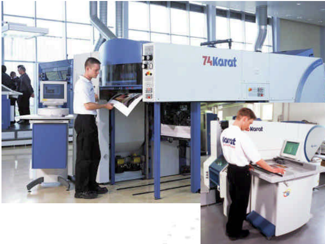
Digital-Offsetdruck farbiger Kleinauflagen mit der 74 Karat und 46 Karat
